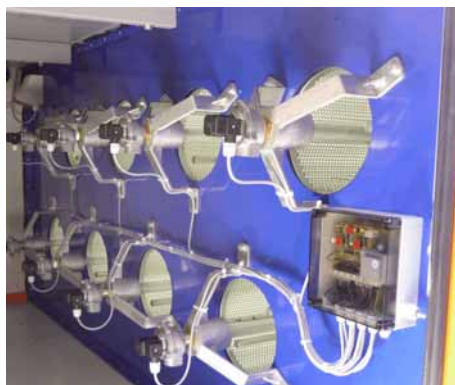
Рис. 3-4: Размещение мембранных клапанов (сторона очищенного газа => 9 "Глоссарий")
